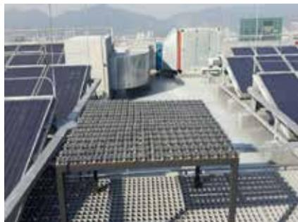
图 2. 深圳某工程自然老化试样放置现场
