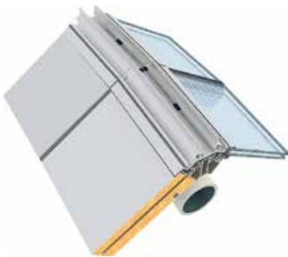
图3 WT01/02 屋面系统构造示意图
