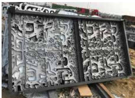
图 8 饕餮板与钢架组装实物照片
