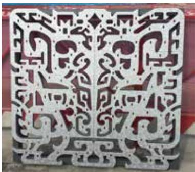
图 6 饕餮纹镂空铝铸件实物照片
